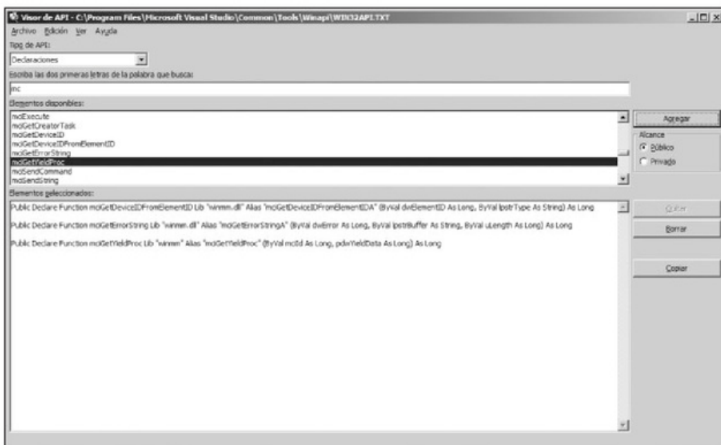
Figura 6. Las Windows API ayudaban a muchos lenguajes de programación a resolver la comunicación con recursos de Windows usando pocas líneas de código. Visual Basic, antes de la era .NET, incluía un Visor de API, para conseguir fácilmente el código que necesitáramos.
