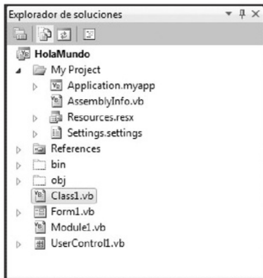
Figura 18. En el Explorador de soluciones podemos ver todos los archivos que contiene nuestra solución, así como agregar y eliminar otros que necesitemos.
