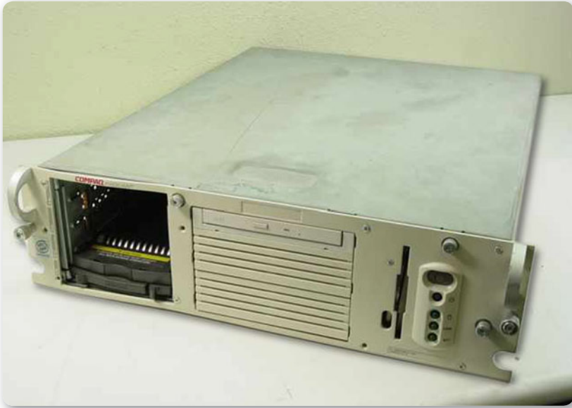
► Figura 6. Uno de los primeros servidores físicos x86 que reemplazaron a los antiguos mainframes.
