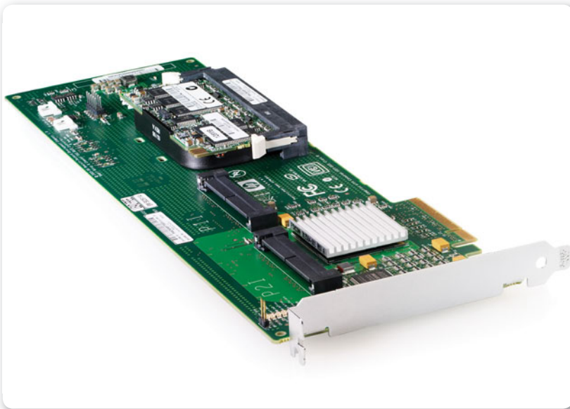
► Figura 4. Esta placa controladora RAID fue diseñada especialmente para servidores de alta performance.
