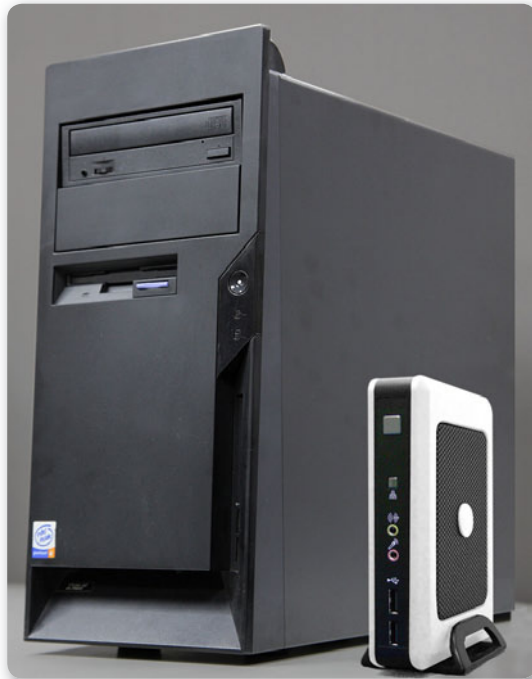
► Figura 7. En esta imagen podemos observar la diferencia de tamaño que existe entre una PC y un thin client.
