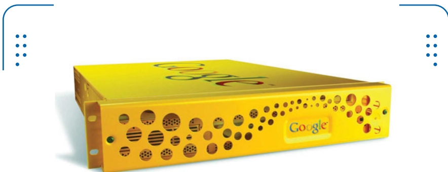
► Figura 1. Un appliance de Google para realizar búsquedas de archivos y sus contenidos dentro de una red LAN.
