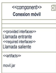
Figura 5.7. Visión interna del componente
