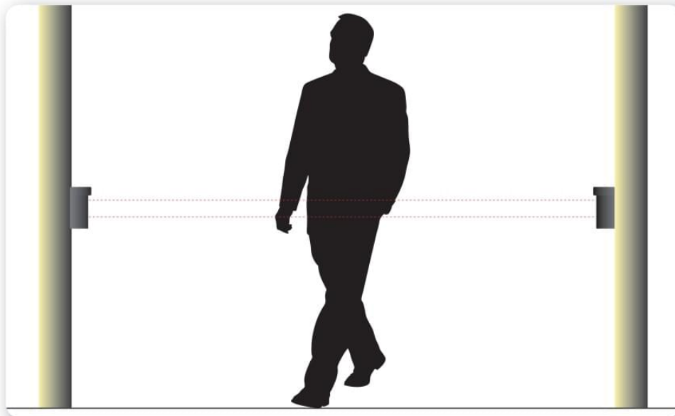
Figura 8. Funcionamiento del sensor de paso.
