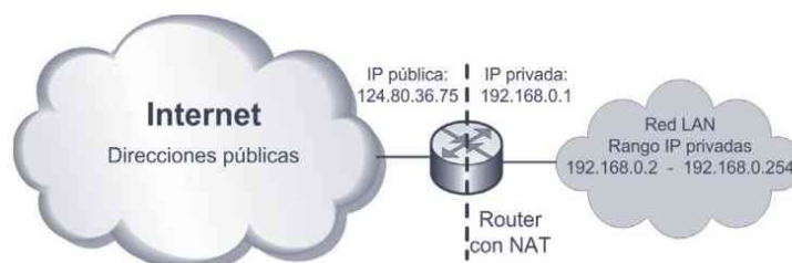
Figura 10.10. Conexión de redes privadas con Internet mediante un router con NAT
