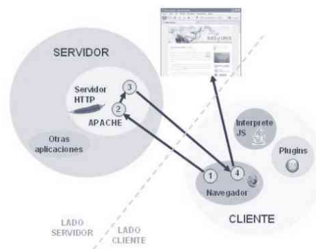
Figura 5.1. Arquitectura cliente servidor en un servidor de páginas estáticas
