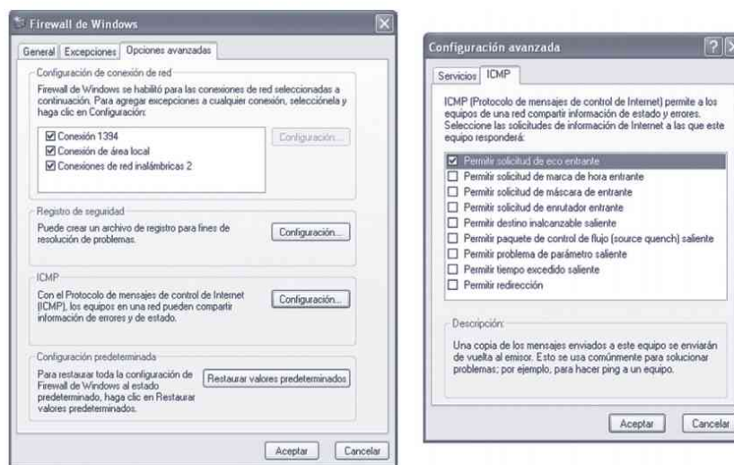
Figura 13.7. Configuración del firewall de Windows® XP para el filtrado de mensajes ICMP
