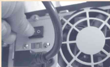
Figura 1.36. Encendido de la fuente de alimentación
