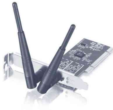
Figura 11.19. NIC inalámbrica IEEE 802.11n que utiliza la funcionalidad MIMO
