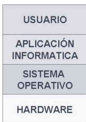
Figura 1.2. Estructura en capas de un sistema informático
