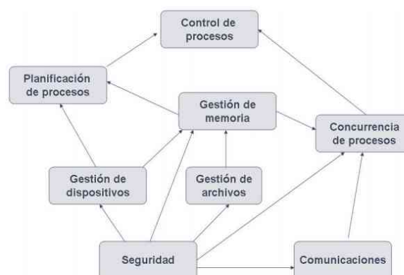
Figura 2.1. Componentes del sistema operativo
