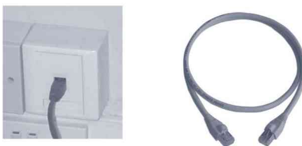
Figura 9.4. Roseta y latiguillo en una red Ethernet
