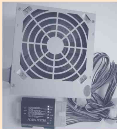
Figura 1.39. Tester conectado a una fuente de alimentación
