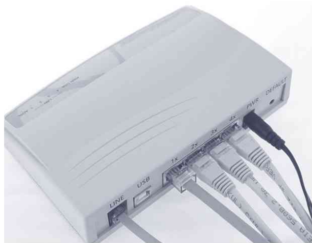
Figura 9.8. Router ADSL con cuatro puertos Ethernet formando una red local de cuatro equipos
