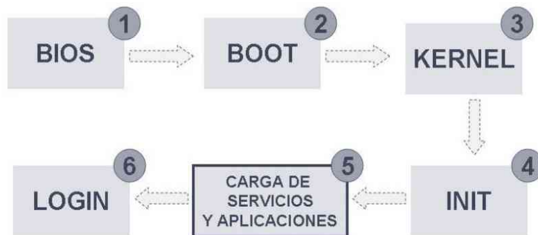
Figura 5.4. Secuencia de arranque de un equipo
