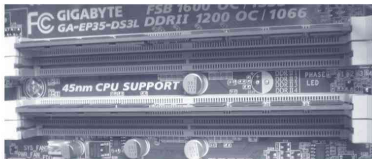
Figura 3.38. Detalle de 2 módulos de memoria en una placa base
