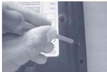
Figura 12.13. Retirando los tornillos de fijación
