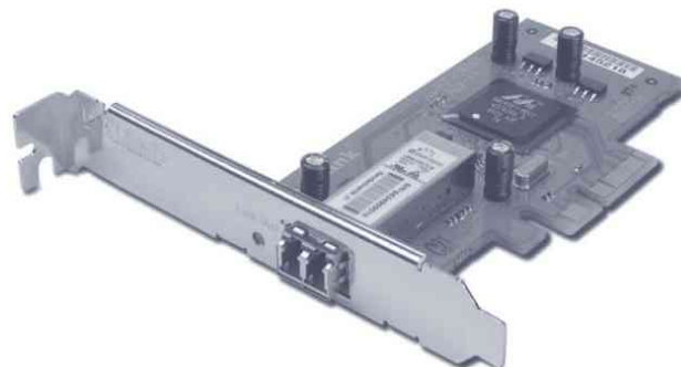
Figura 9.10. Tarjeta Gigabit Ethernet (DLink DGE-560SX) que utiliza fibra óptica en lugar de cable UTP
