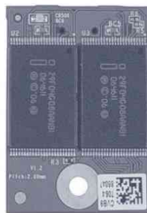
Figura 1.31. Parte trasera de un disco SSD. Fuente Intel®
