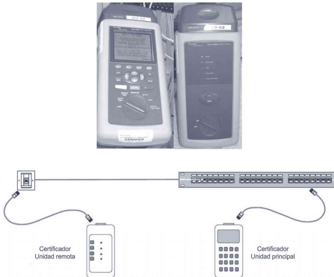
Figura 8.35. Certificador de cableado
