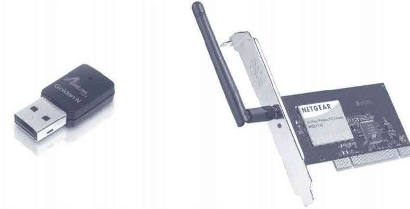
Figura 11.18. NIC inalámbrica por USB conocida como USB Wi-Fi y NIC inalámbrica por puerto PCI
