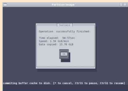
Figura 12.26. Partition Image. Finalización del proceso de clonación
