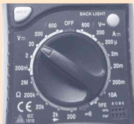
Figura 3.14. Configuración del selector rotatorio
