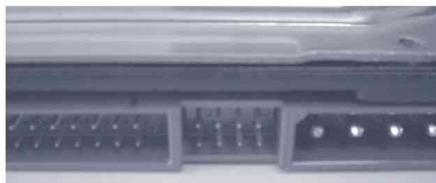
Figura 3.39. Configuración de jumper de un disco duro
