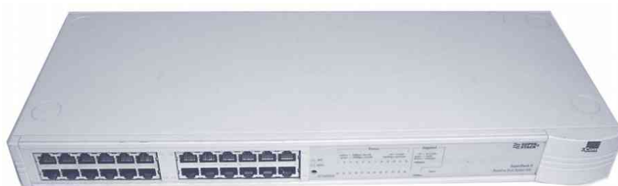
Figura 9.30. El modelo de hub 3com Superstack II de 24 puertos fue muy utilizado en redes LAN
