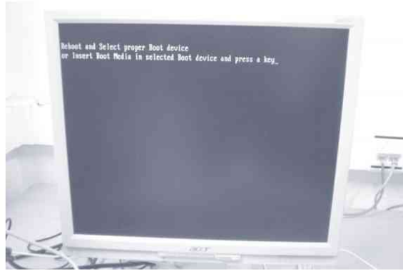
Figura 12.7. Arranque del equipo por primera vez. El sistema operativo no está instalado
