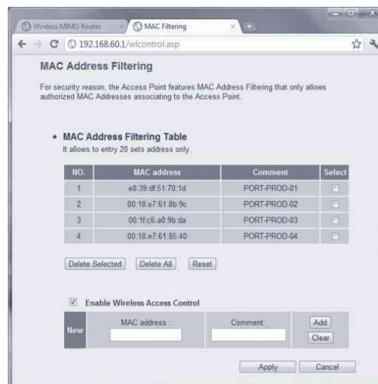
Figura 11.15. Ejemplo de configuración de filtrado de direcciones MAC
