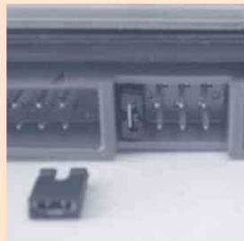
Figura 3.43. Configuración de jumper de un disco duro
