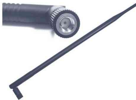
Figura 11.12. Antena Wi-Fi con el detalle del conector coaxial
