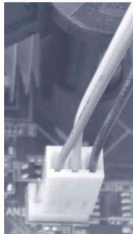
Figura 3.33. Conexión de alimentación del fan del disipador de la CPU
