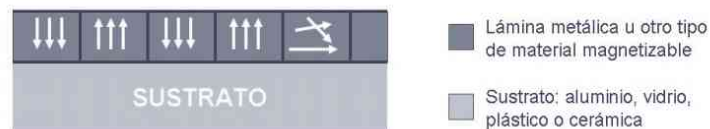
Figura 1.22. Composición del plato de un disco duro
