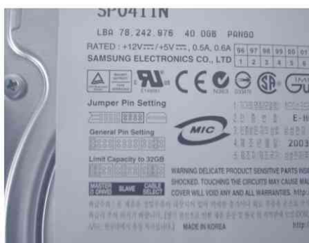
Figura 3.41. Tabla de configuración de jumper de un disco duro
