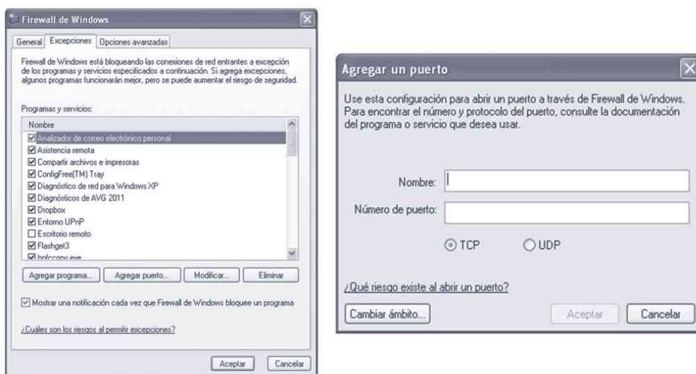
Figura 10.27. Ventana de excepciones del firewall y para agregar un puerto a las excepciones
