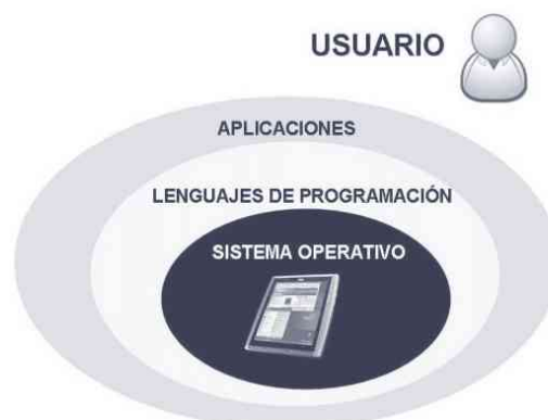
Figura 6.2. Esquema tipo cebolla Hw-SO-Sw Aplicación
