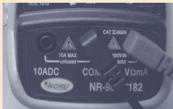
Figura 3.13. Detalle de la conexión de las puntas del multímetro
