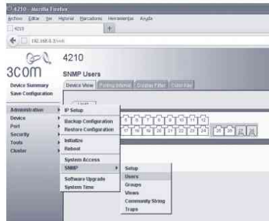
Figura 13.20. Configuración SNMP en un switch
