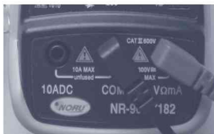
Figura 3.12. Detalle de los conectores de las puntas del multímetro
