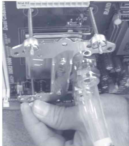
Figura 3.1. Instalación de una refrigeración líquida
