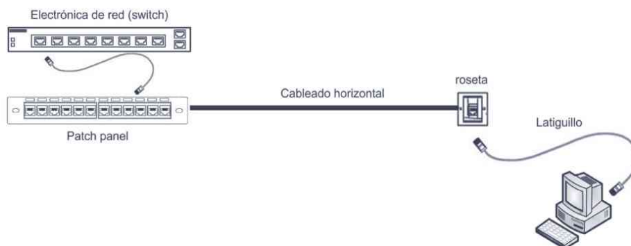
Figura 8.30. Partes que componen el subsistema horizontal
