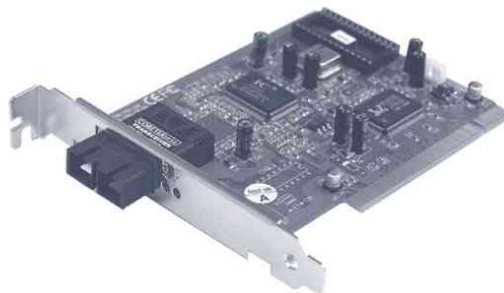
Figura 9.24. Tarjeta Gigabit Ethernet con conectores SC
