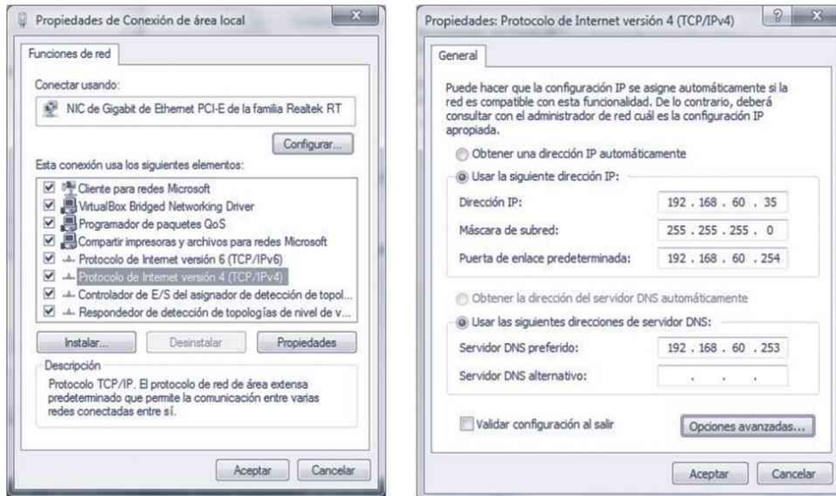
Figura 10.21. Ventanas para la configuración de red en Windows® 7
