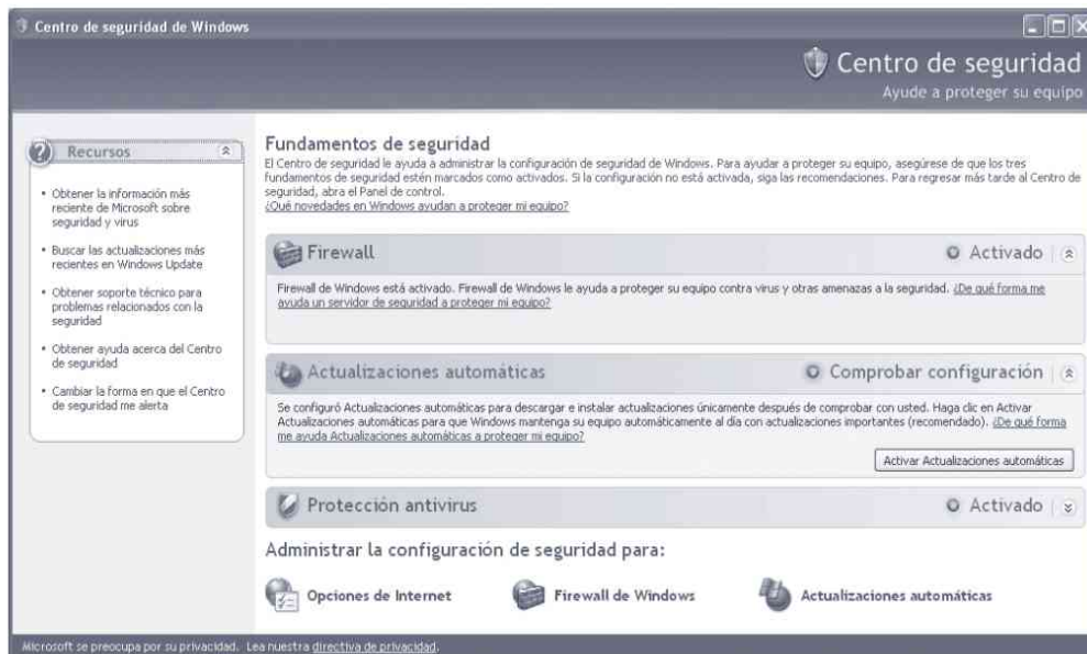
Figura 10.25. Ventana Centro de seguridad desde donde se puede acceder al firewall de Windows® XP
