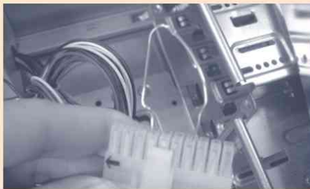
Figura 1.35. Puenteo del conector macho ATX
