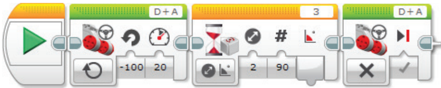
Programa 13. Control del giro mediante el sensor giroscópico 'Gira90Giroscopo.ev3'
