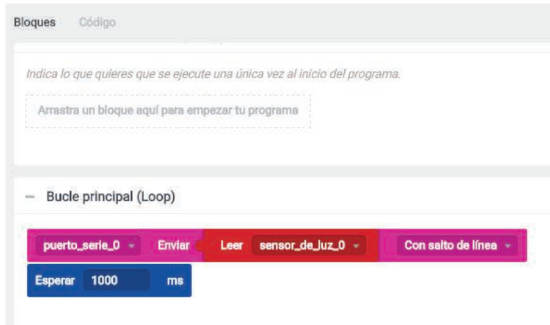
Figura 1.2-90. Programación por bloques de la lectura de un LDR y su envío por puerto serie
