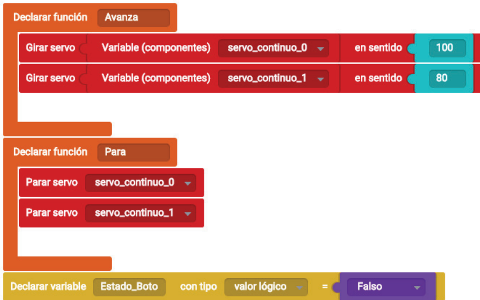
Figura 1.2-46. Funciones y variables para mover un motor con un botón y velocidad variable
