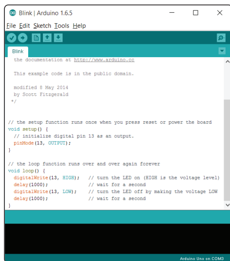
Figura 1.1-49. Ejemplo de uso del IDE de Arduino: LED parpadeante
