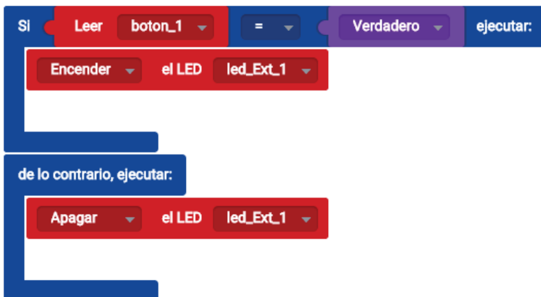
Figura 1.2-20. Programa en Bitbloq para encender un LED con un botón
