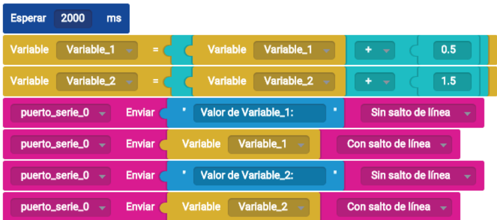
Figura 1.2-36. Programa en Bitbloq para enviar los valores de 2 variables por puerto serie
