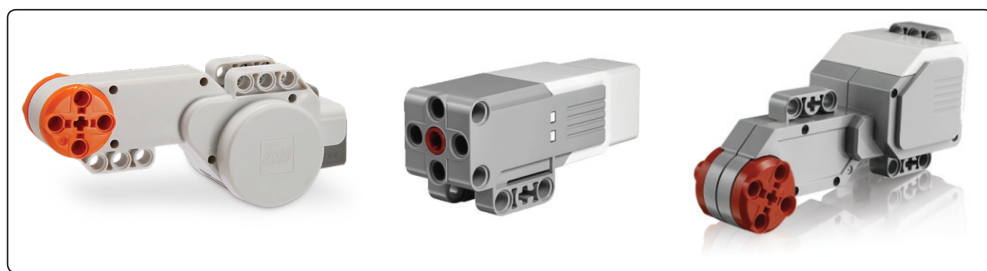
Figura 2.3-3. Motores de Lego Mindstorms. De izquierda a derecha: motor NXT, motor mediano EV3, motor grande EV3
