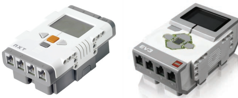
Figura 2.1-15. Microcontroladores de Lego Mindstorms. Izq.: brick de NXT. Dch.: bloque de EV3
