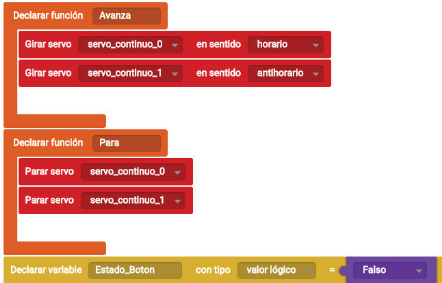
Figura 1.2-45. Funciones y variables para mover un motor con un botón
