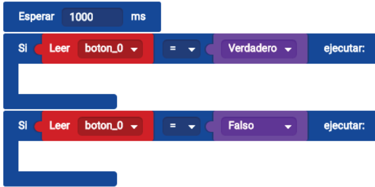
Figura 1.2-30. Sentencias condicionales para comprobar el estado del botón
