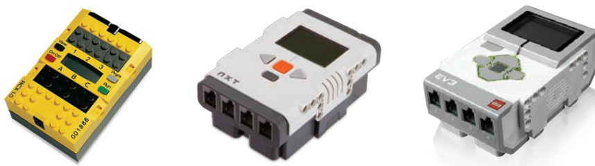
Figura 2-2. Distintos bloques de control de Lego Mindstorms. De izquierda a derecha: RCX, NXT y EV3
