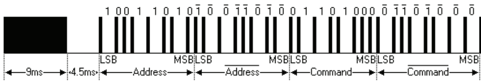
Figura 4.5-2. Decodificación de una traba con protocolo de la compañía NEC
