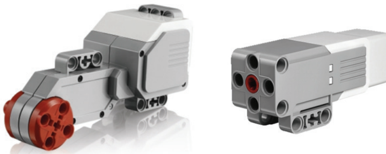
Figura 2.1-7. Motores de Lego EV3. Izq: motor grande. Dch: motor mediano
