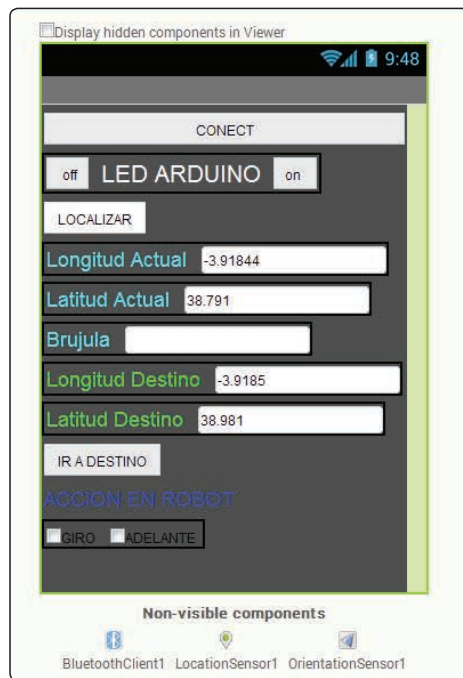
Figura 3.2-22. Diseño de la App en APP Inventor para la navegación autónoma de un robot
