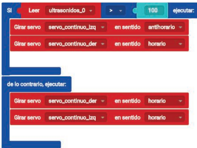
Figura 1.2-78. Programación por bloques de un robot evita obstáculos
