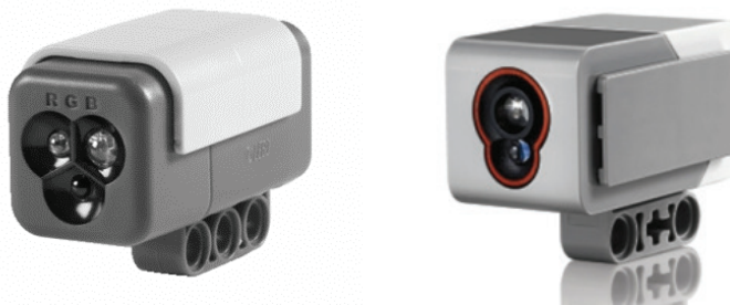
Figura 2.1-8. Sensores de color. Izq: Lego NXT. Dch: EV3
