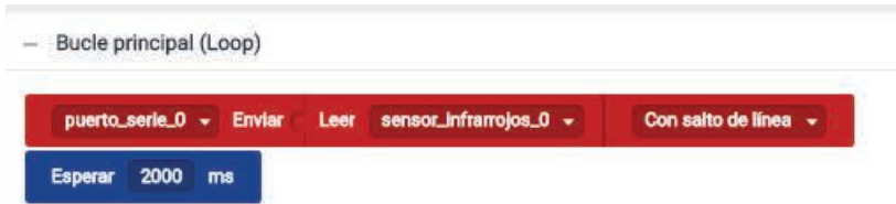
Figura 1.2-64. Programa por bloques para envío de la lectura del sensor de infrarrojo
