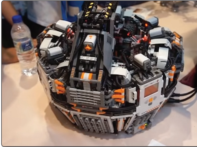
Figura 4.10-3. Robot CubeStormer. Campeón del mundo de resolución de cubos de Rubik.
