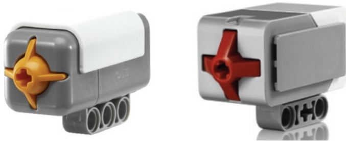
Figura 2.1-9. Sensores de contacto. Izq: Lego NXT. Dch: EV3
