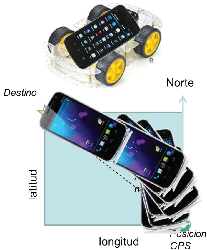
Figura 3.2-21. Robot con un móvil colocado encima (Imagen Superior) y trayectoria que realiza hasta llegar al destino (imagen inferior)
