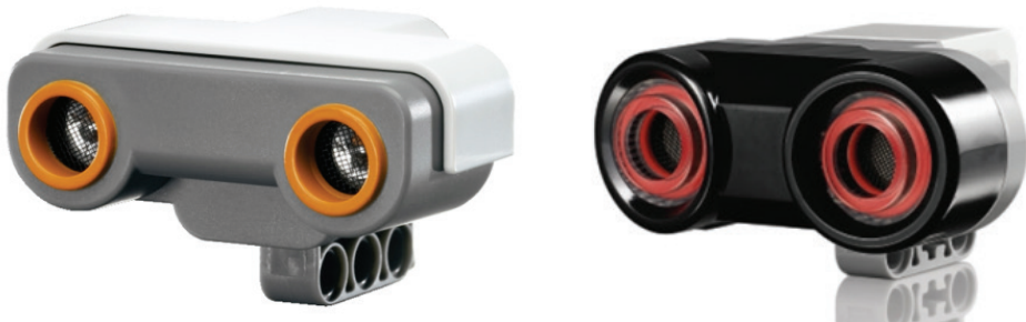
Figura 2.1-14. Sensor de ultrasonidos. Izq.: NXT. Dch.: EV3
