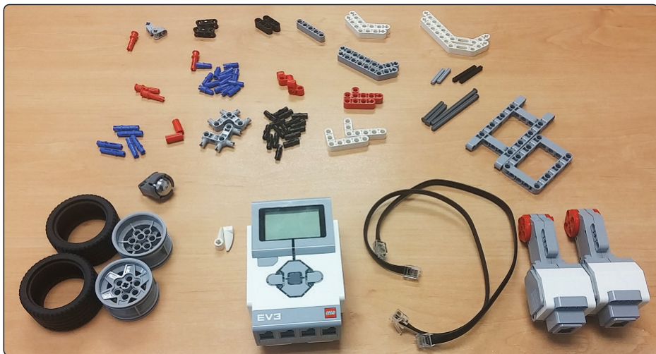
Figura 2.2-18. Piezas necesarias para construir la base móvil del robot Educator
