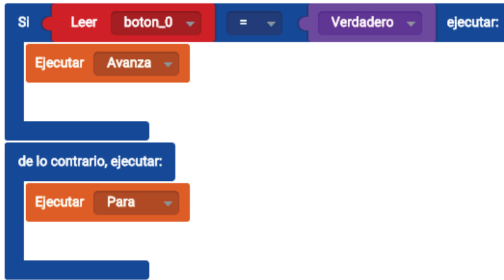
Figura 1.2-44. Código en Bitbloq para mover dos servomotores con un botón
