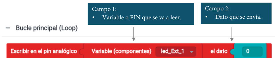
Figura 1.2-12. Programa en Bitbloq para cambiar la intensidad de un LED
