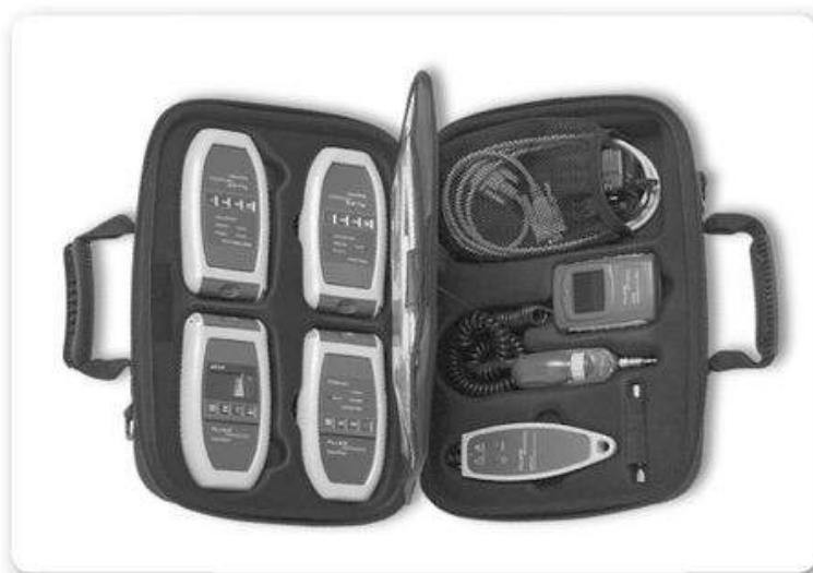
► Figura 15. Existen kits de fibra óptica, que brindan las herramientas para comprobar los niveles de potencia monomodo y multimodo.
