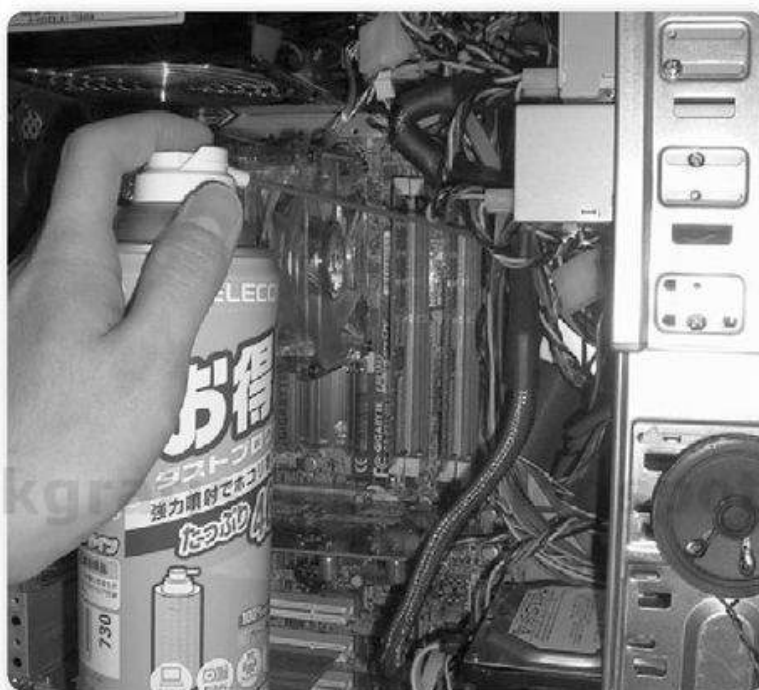
► Figura 9. Podemos utilizar una lata de aire comprimido para eliminar el exceso de polvo de un gabinete.
