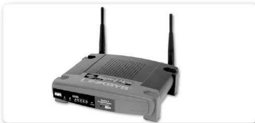
► Figura 15. Los routers trabajan en esta capa de red permitiendo que los paquetes de datos sean direccionados al destino adecuado.
