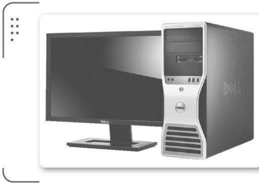
► Figura 3. Las estaciones de trabajo de alto rendimiento son equipos específicos como el de esta imagen.
