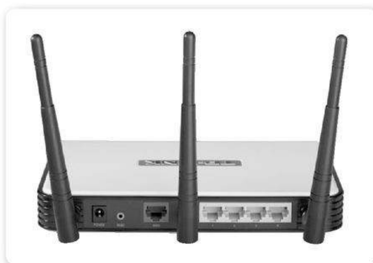
► Figura 19. Un router inalámbrico posee varias interfaces. Se trata de un dispositivo muy utilizado en redes domésticas.
