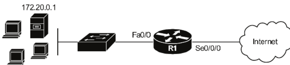
Fig. 7-12 Diseño de red para supuesto práctico de NAT estático.
