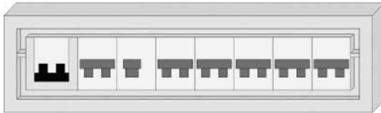
Figura 1.7. Cuadro de protección de una vivienda
