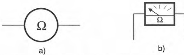
Figura 3.18. a) Símbolo general de un óhmetro. b) Tipo clásico, se basa en un galvanómetro (medición analógica).
