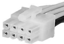
Figura 7.20. Conector ATX 12V de 8 pines.
