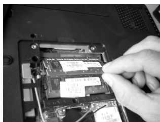
Figura 6.15. Instalación de los nuevos módulos de memoria RAM.
