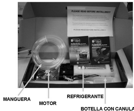
Figura 5.84. Componentes de un kit de refrigeración líquida.
