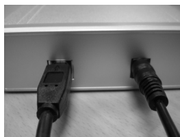
Figura 5.70. Conexión de la carcasa al puerto USB y al transformador.
