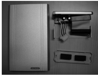
Figura 5.65. Elementos de una carcasa USB IDE.
