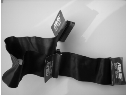
Figura 1.15. Cable bus IDE. (Utilizado para conectar placa base y lector óptico o HD)
