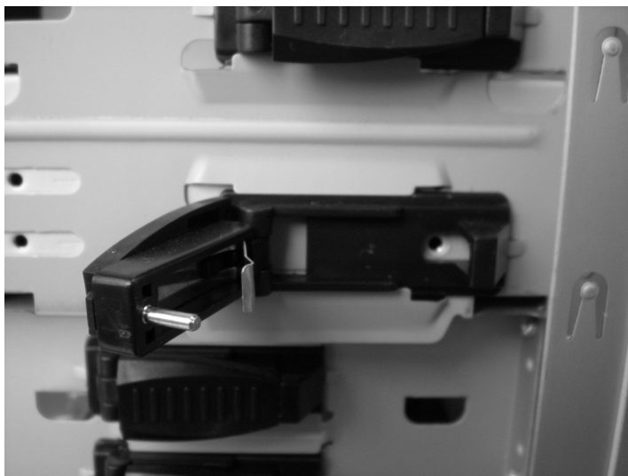
Figura 2.23. Sistema de fijación de las bahías
