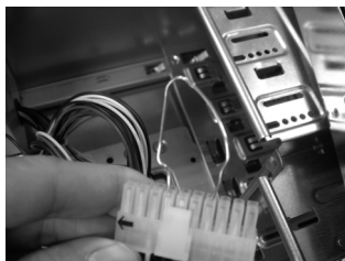
Figura 7.24. Puenteo del conector macho ATX.
