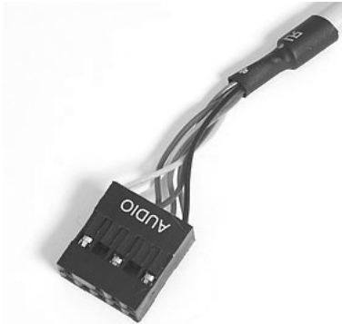
Figura 2.22. Conector de sonido de la placa base al lector óptico
