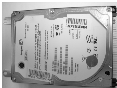
Figura 6.18. Disco duro IDE fuera del equipo portátil.
