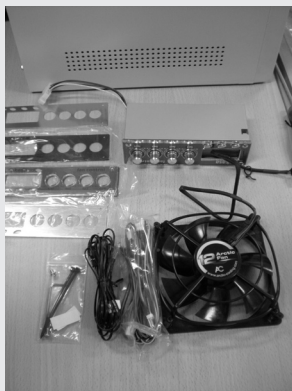
Figura 5.107. Elementos de un control de ventiladores.
