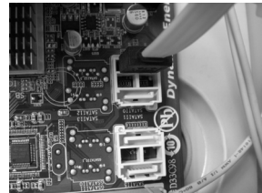
Figura 5.62. Ajustando el conector de datos SATA a la placa base.
