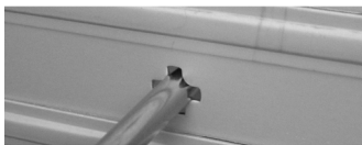
Figura 5.78. Retirada de la chapa del slot.
