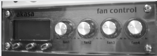
Figura 5.112. Panel encastrado y fijado.
