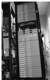
Figura 9.32. Cluster de servidores (33 nodos). Fuente iconoclast.
