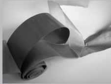
Figura 1.39. Contenido interior de un condensador desenrollado
