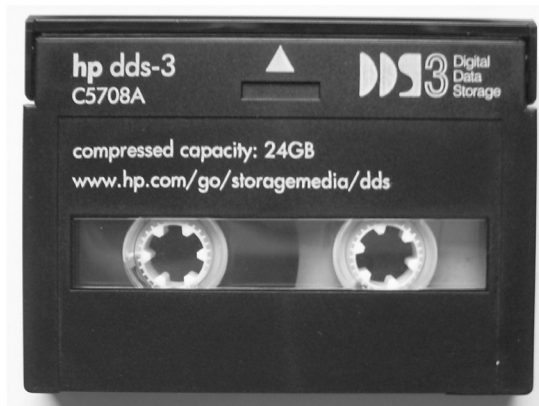
Figura 3.23. Cinta magnética DDS3. Capacidad 24GB.
