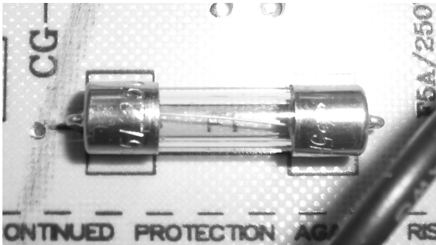
Figura 1.48. Detalle de un fusible dentro de una fuente de alimentación
