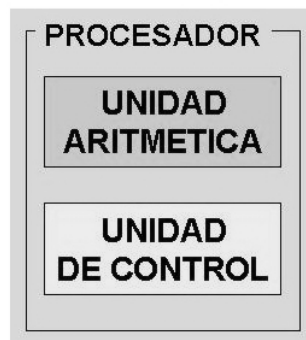
Figura 1.7. Esquema básico de un procesador
