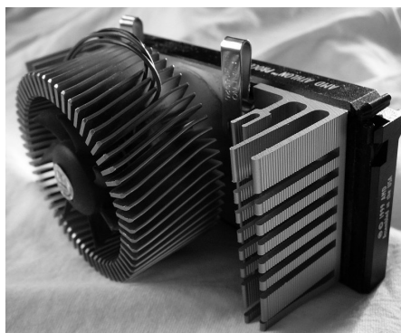
Figura 2.52. Disipador AMD® Athlon K7. Fuente flickrsven
