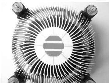
Figura 5.6. Disipador de aluminio con pasta térmica en el centro.
