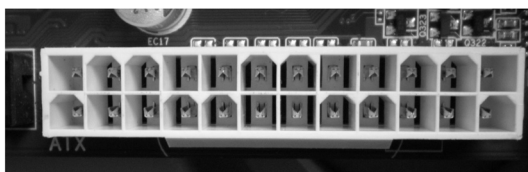
Figura 5.12. Conector ATX de la placa de 24 pines.
