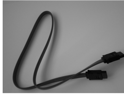
Figura 1.16. Cable bus SATA. (Utilizado para conectar placa base y HD/Unidad óptica en equipos recientes. Sustituye al cable IDE)
