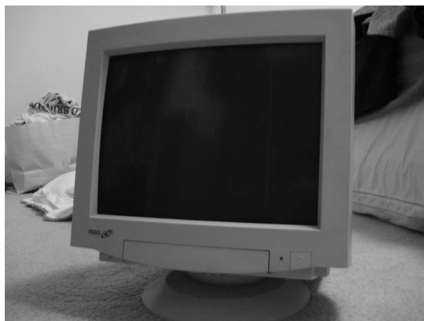
Figura 7.42. Monitor CRT. Este monitor tiene alto contenido en plomo.
