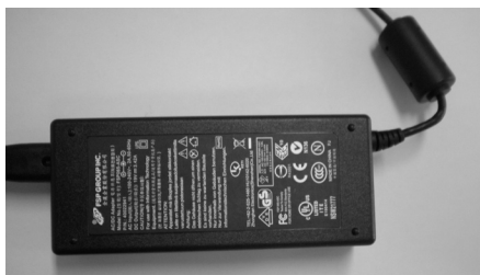
Figura 1.43. Transformador de un equipo portátil
