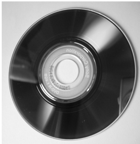
Figura 3.28. DVD-R 8 milímetros. Usado sobre todo en cámaras de vídeo.
