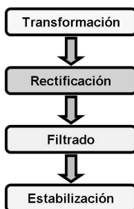
Figura 7.17. Esquema de funcionamiento de una fuente de alimentación.
