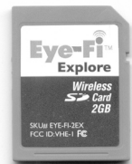
Figura 9.17. Tarjeta SD con tecnología wireless. Fuente Remko van Dokkum.
