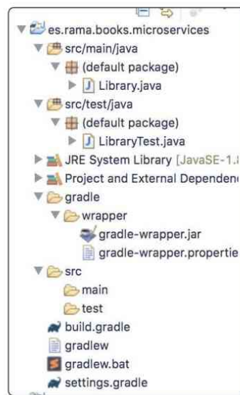
Figura 3.7. Estructura de un proyecto Gradle en Eclipse
