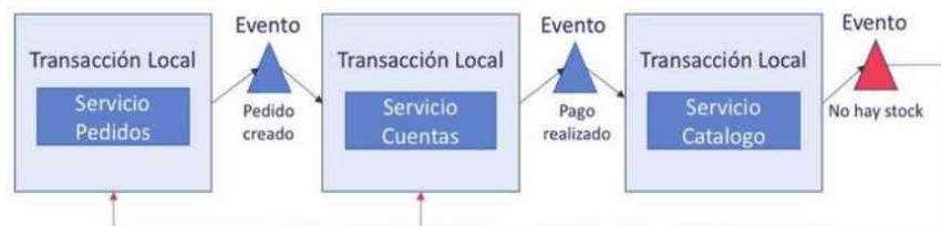
Figura 7.3. Rollback en una transacción en saga con coreografía
