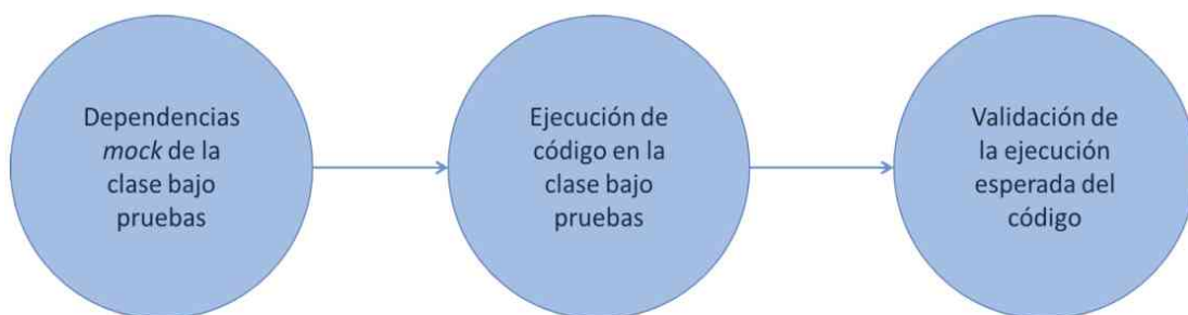
Figura 8.1. Estructura de una prueba con Mockito
