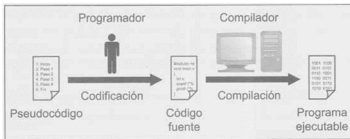
Figura 1.9. Proceso de transformación del algoritmo en pseudocódigo al programa ejecutable.
