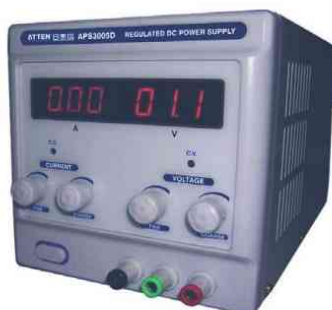
Figura 8.3. Fuente de alimentación regulable
