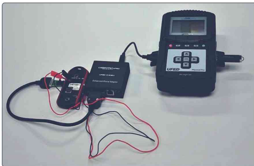
Figura 7.1. Cellebrite UFED equipado para la adquisición de teléfonos móviles chinos
