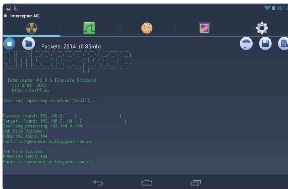
Figura 6.5. Interceptor-ng captando el tráfico inalámbrico circundante
