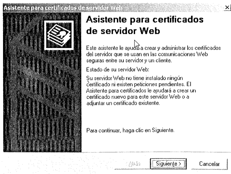
Figura 10.80. Asistente instalación certificado servidor Web
