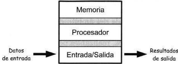
Figura 1.3 Esquema general de un computador.
