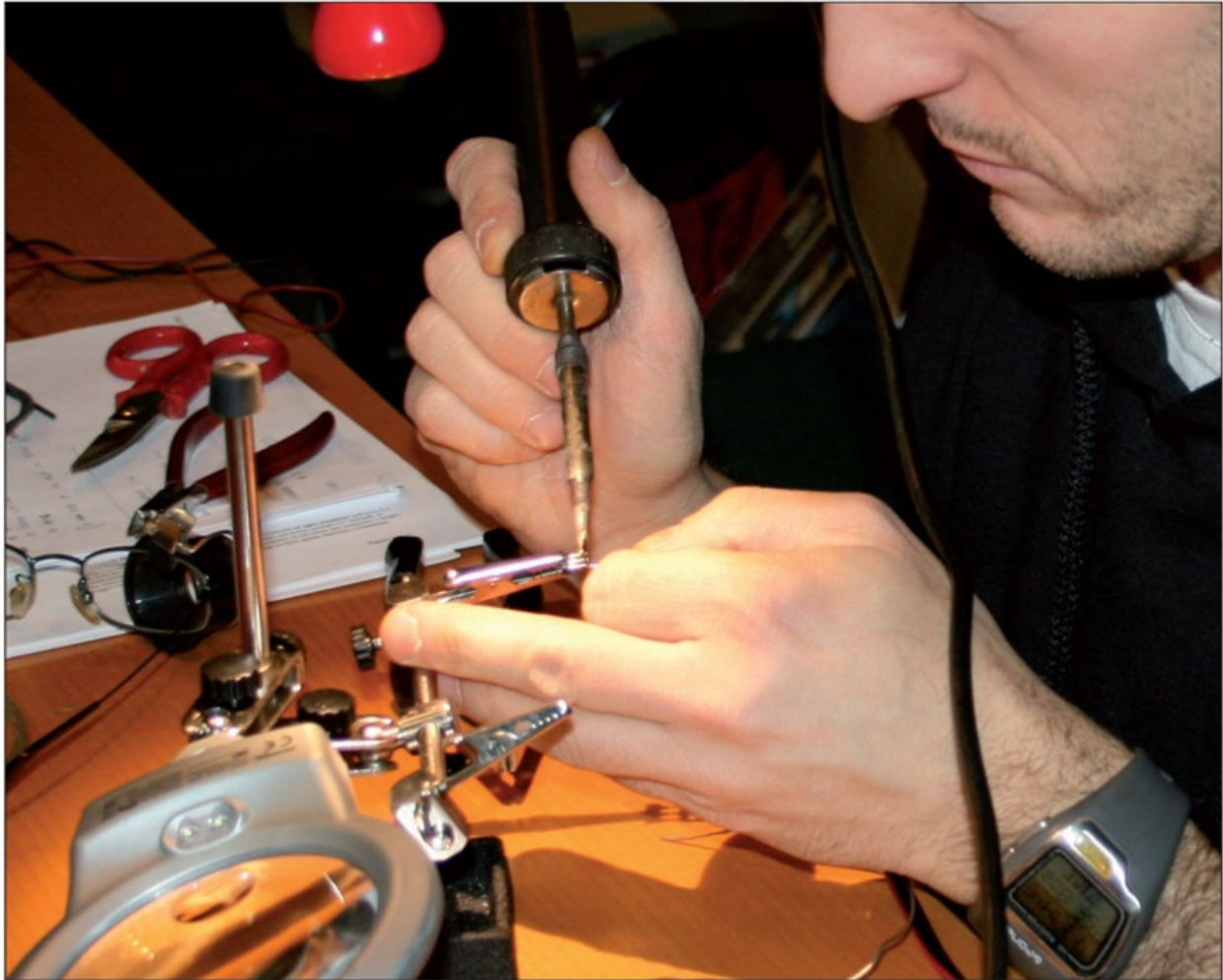
Figura 3.19 – Cogemos el soldador como si fuera un lápiz, sujetándolo entre el pulgar, índice y corazón y apoyándonos sobre la mesa.
