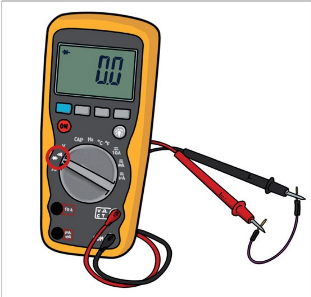
Figura 3.9 – Uso de un tester con la función prueba diodos para comprobar la continuidad de un jumper .
