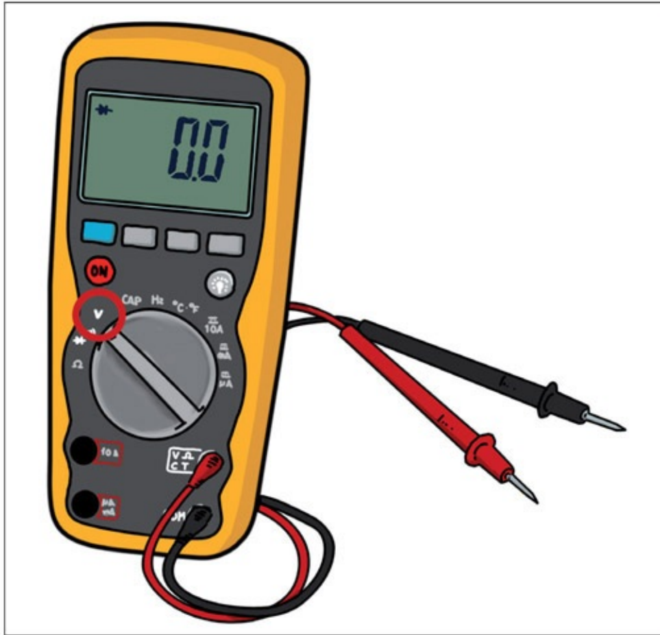
Figura 1.27 - Para medir tensiones, las sondas deben situarse en los bujes COM y V/Ω. El selector del flujo debe colocarse en V o VDC.
