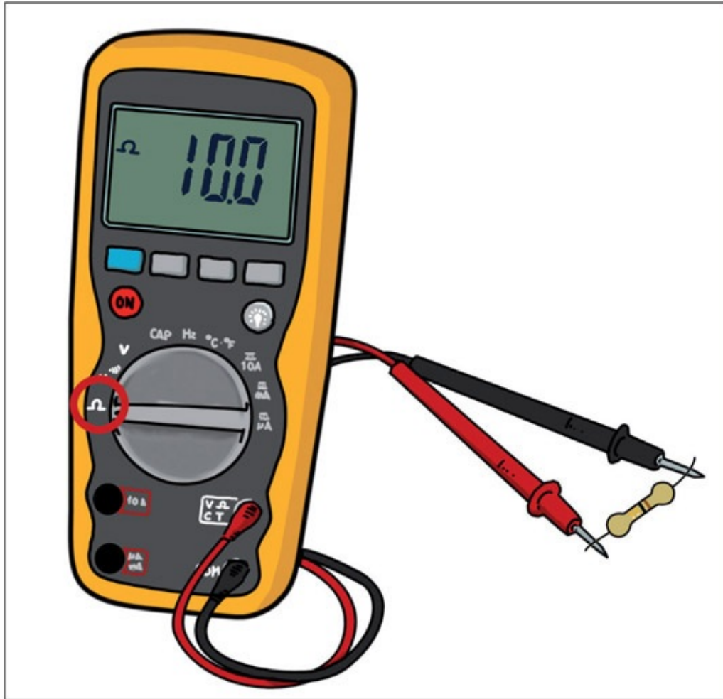
Figura 2.21 – Uso de un tester para medir una resistencia: las sondas están insertadas en los bujes COM y V/ \Omega , y el flujo se ajusta en un valor adecuado.
