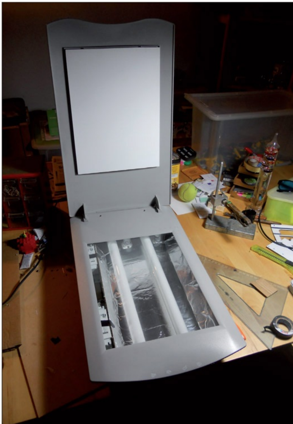
Figura 10.21 – Una impresora de contacto creada con un viejo escáner en el cual se han colocado dos tubos UV.
