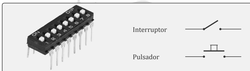
Figura 5.11 El símbolo empleado para representar un interruptor depende del tipo de switch . A la derecha se muestran dos símbolos
