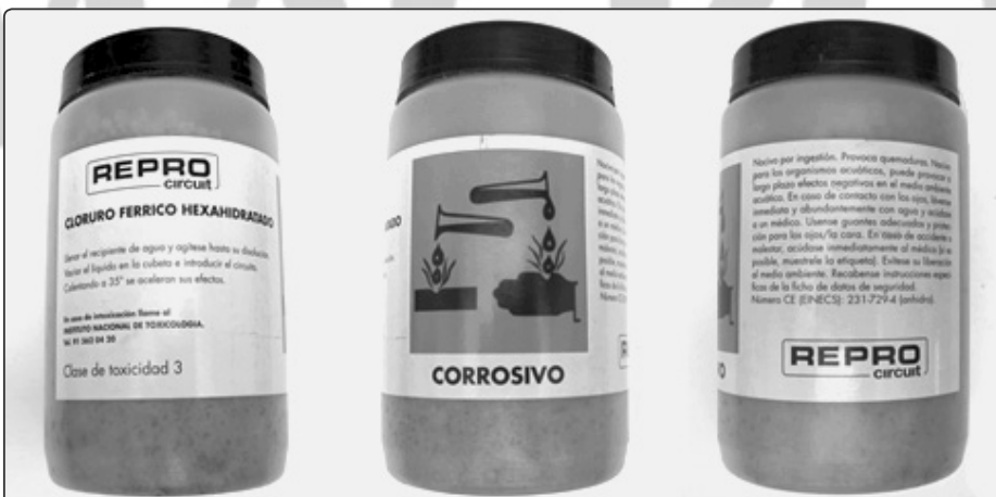
Figura B.9 El cloruro férrico, químico muy utilizado para la corrosión de cobre en PCB
