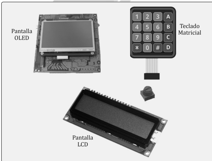
Figura 1.5 La pantalla LCD y el teclado matricial, ejemplos de dispositivos electrónicos
