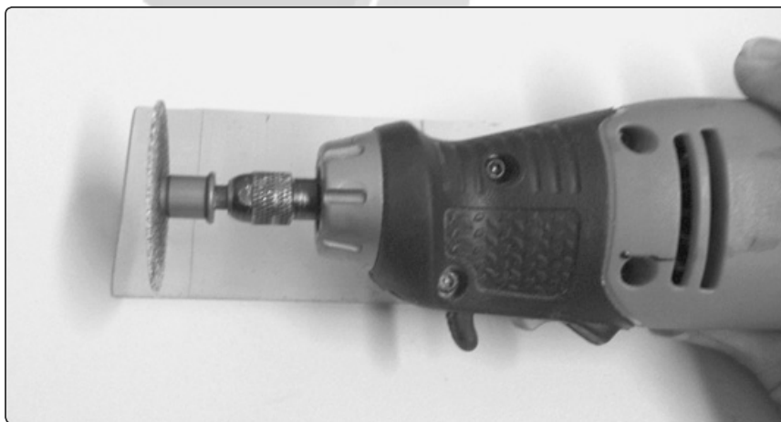
Figura B.7 El dremel, herramienta fundamental para efectuar cortes, pulido y perforación de PCB
