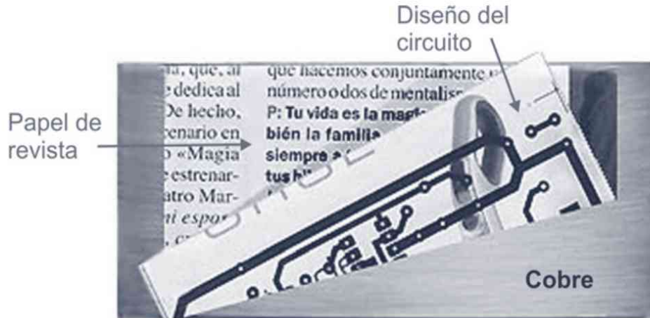
Figura 13.19. Diseño de un circuito impreso en papel satinado de revista
