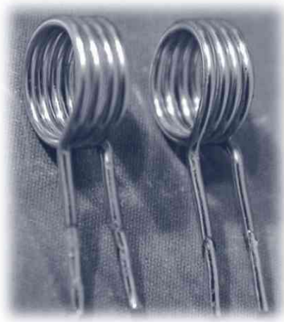
Figura 7.2. Bobinas rectas con núcleo de aire
