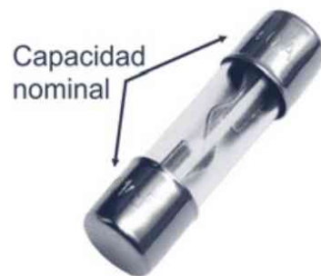
Figura 4.1. Fusible de cristal con una capacidad nominal de 40 A
