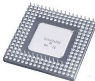
Figura 12.6. Encapsulado de un microprocesador
