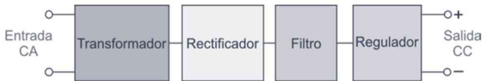
Figura 14.2. Elementos constitutivos de una fuente de alimentación regulada
