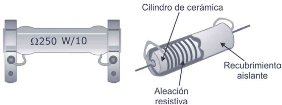
Figura 5.1. Resistencia de potencia. El valor óhmico y la potencia se marcan directamente en el cuerpo de la misma
