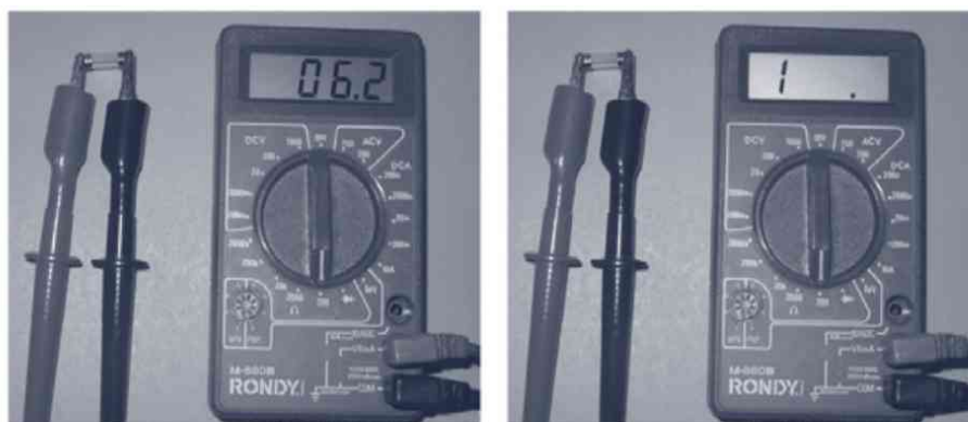
Figura 4.7. Medidas de continuidad en un fusible. El fusible de la imagen de la izquierda se encuentra en perfecto estado, mientras que el de la derecha está fundido, pues no existe continuidad
