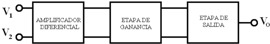
Figura 14.2. Etapas en un amplificador operacional.
