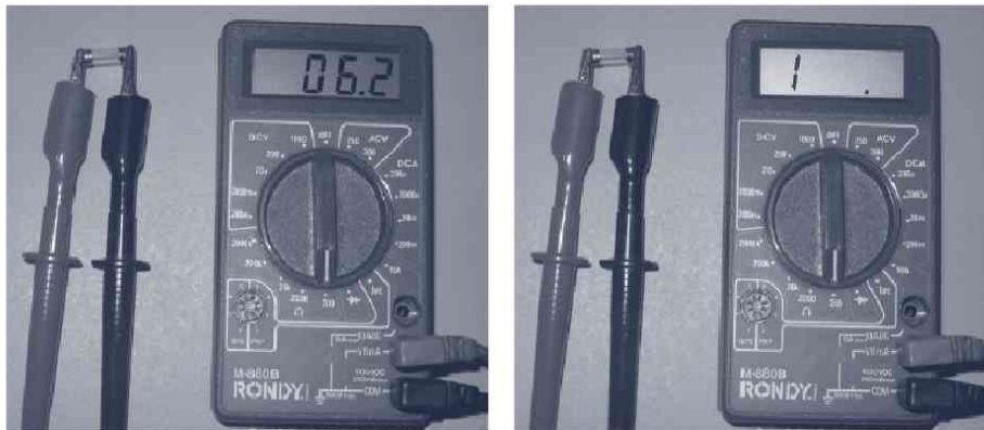
Figura 9.6. Medidas de continuidad en un fusible. El fusible de la imagen de la izquierda se encuentra en perfecto estado, mientras que el de la derecha estaría fundido, pues no existe continuidad
