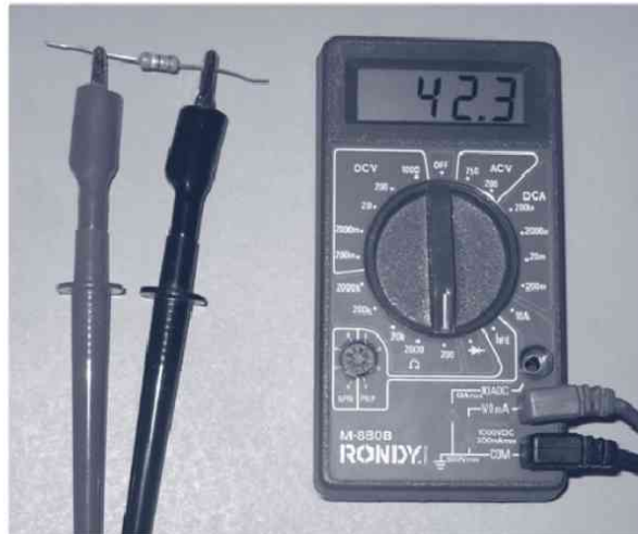
Figura 9.4. Comprobación de una resistencia de 43 \Omega .
