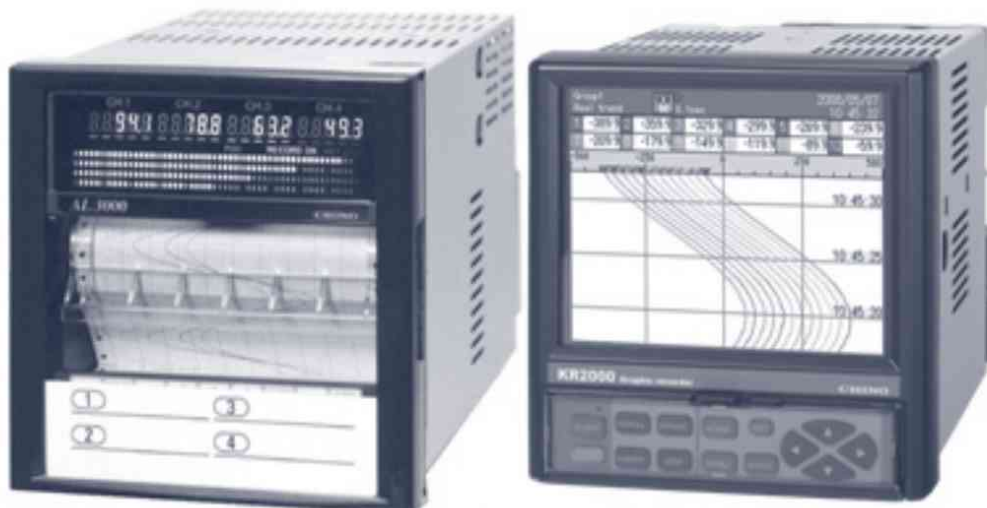
Figura 8.3. Registradores de tensión. Se observa un registrador de papel, izquierda, y uno videográfico, derecha
