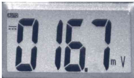
Figura 9.1. Pantalla de un polímetro digital. Se aprecia una lectura de 16,7 mV en tensión continua
