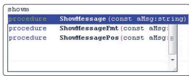
Figura 10.4. Completado de identificador con las opciones posibles
