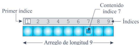
Figura 4.1. Arreglo unidimensional o vector de longitud 9
