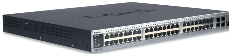
Figura 7.15. Moderno switch de 52 puertos (48+4) de la marca D-Link
