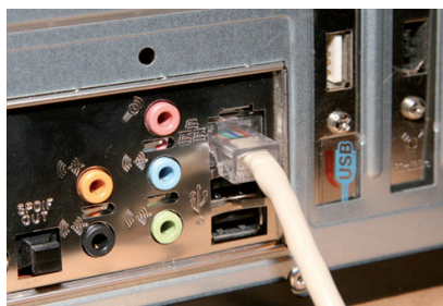
Figura 6.10. Tarjeta de red incluida en la placa base de un equipo
