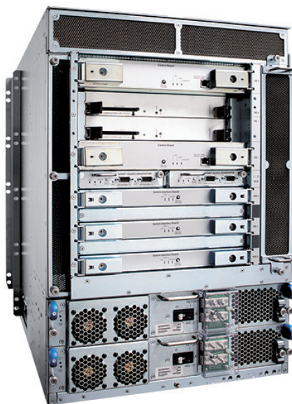
Figura 7.7. Router de distribución de la marca Juniper
