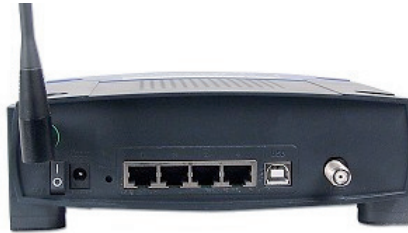
Figura 7.5. Conexiones en un router residencial de cable
