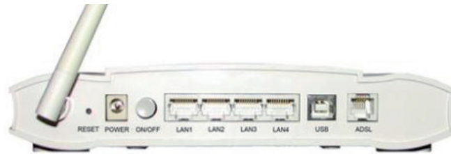
Figura 7.4. Conexiones en un router residencial ADSL
