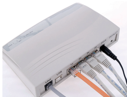
Figura 6.8. Router ADSL con cuatro puertos Ethernet formando una red local de cuatro equipos
