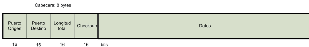
Figura 5.17. Formato del paquete UDP
