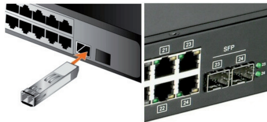
Figura 7.24. Puertos modulares para módulos SFP
