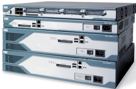
Figura 7.6. Routers de acceso de la serie 2800 de Cisco
