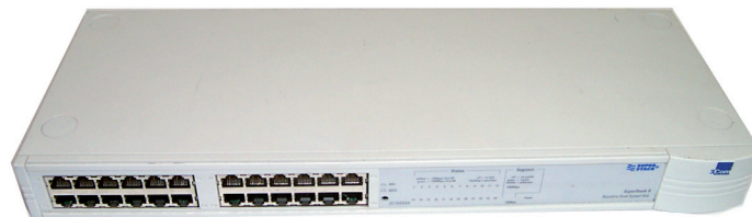
Figura 7.13. El modelo de hub 3com Superstack II de 24 puertos fue muy utilizado en redes LAN
