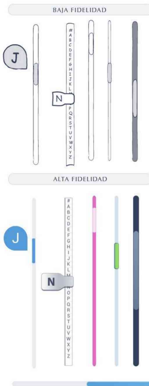
Figura 3-20 Algunos ejemplos de barras de desplazamiento de diferentes tamaños y orientaciones. También se puede ver un ejemplo de la barra de desplazamiento alfabética muy utilizada en aplicaciones móviles.
