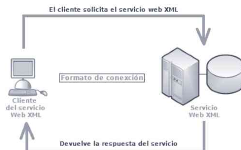
Figura 9.13. Formato de conexión de un servicio web
