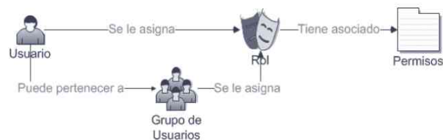
Figura 5.1. Ejemplo de ACL para usuarios basado en roles o perfiles
