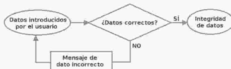
Figura 8.6. Esquema de validación en el servidor
