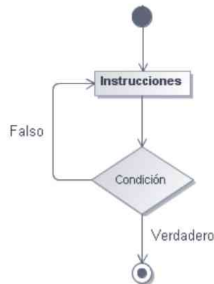
Figura 3.7. Diagrama de control de flujo del bucle do...loop until
