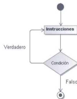
Figura 3.5. Diagrama de control de flujo del bucle do-while
