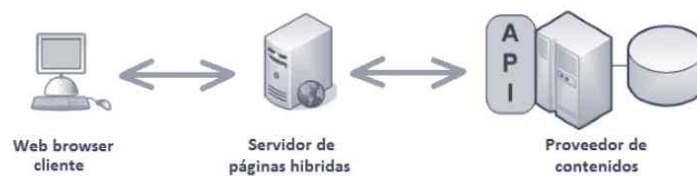
Figura 9.4. Elementos de una arquitectura mashup con API
