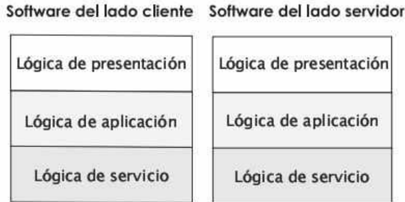
Figura 5.5. Arquitectura de software para una aplicación cliente-servidor.
