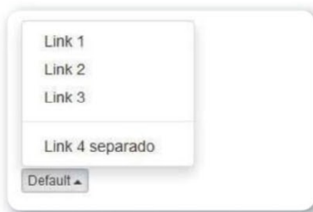
Figura 20. La clase dropdown , además, cambiará el sentido de la flecha del botón.
