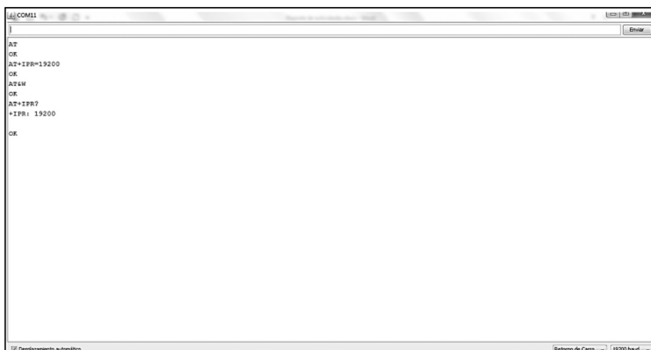
Figura 9.61 Tecleando el comando AT+IPR?
