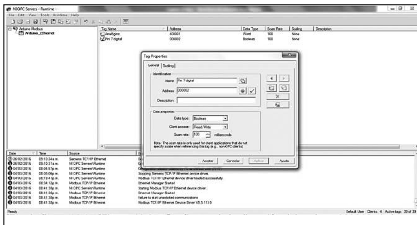
Figura 10.37 Configurando la dirección del registro 000002 al pin digital 7 de Arduino.
