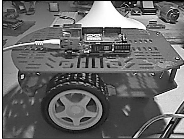
Figura 12.6 Tarjeta YUN montada en el carrito que será el cuerpo del robot.
