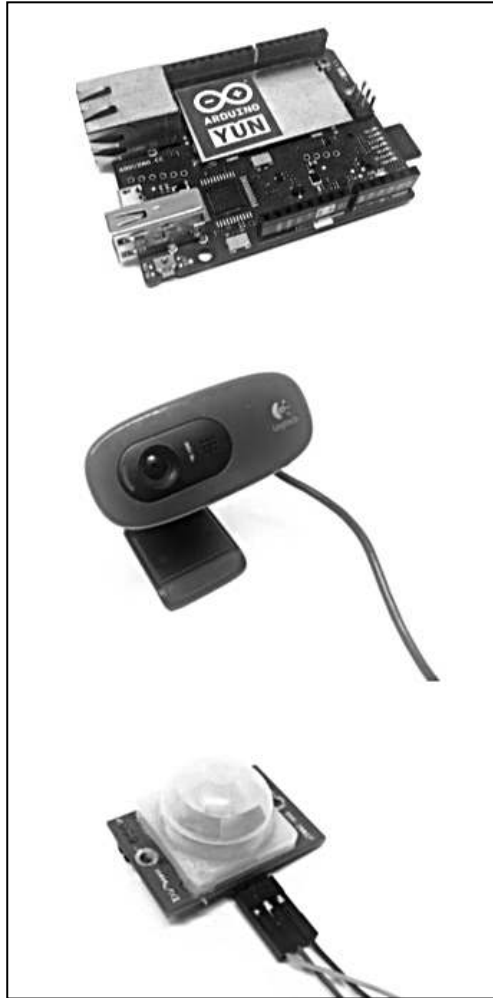
Figura 9.83 Material para el monitoreo remoto con cámara web conectada a la nube.
