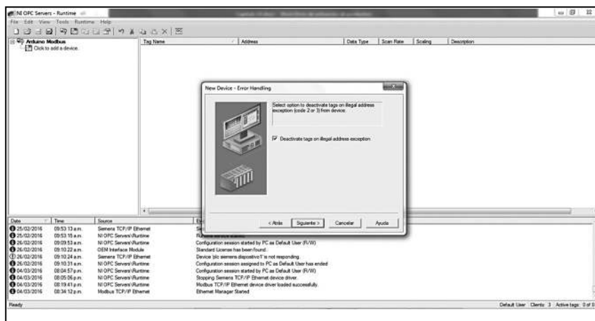
Figura 10.29 Desactivar las tags en direcciones ilegales.
