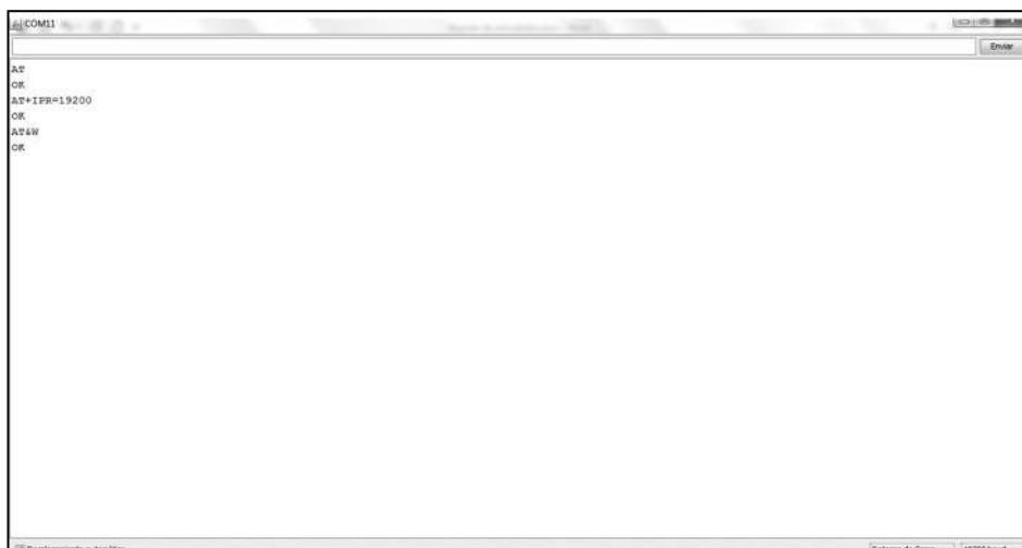
Figura 9.60 Tecleando el comando AT&W.
