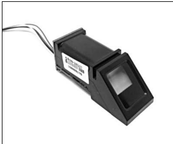
Figura 9.70 Sensor de huella digital.
