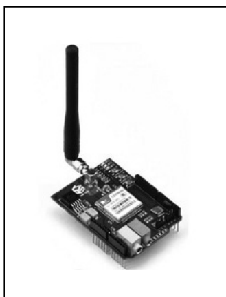
Figura 9.52 Módulo GSM/GPRS para Arduino con módem SIM900.
