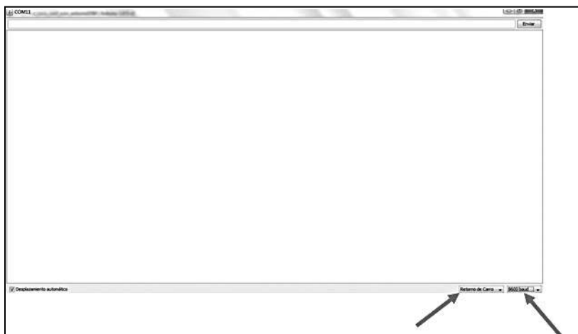
Figura 9.57 Estableciendo el puerto serial y configurando la velocidad y el retorno de carro.
