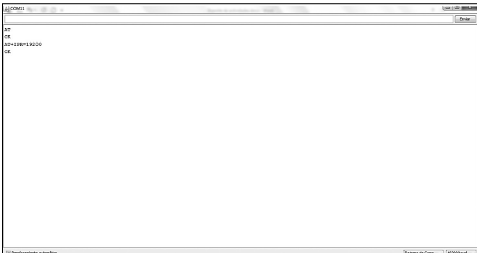
Figura 9.59 Tecleando comando AT+IPR.
