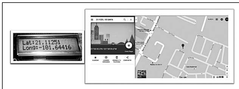
Figura 11.5 Coordenadas recibidas del GPS en la pantalla LCD y Google Maps.
