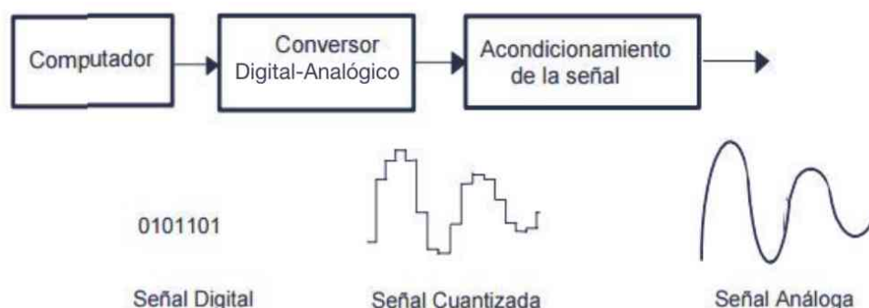
Figura 1.40. Diagrama de bloques de un Convertidor Digital Analógico ( http://quidel.inele.ufro.cl/~jhuircan/PDF_CTOSII/ad03.pdf )
