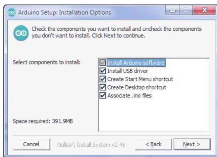
Figura 6.3. Instalación IDE Arduino. Consulta sobre los componentes que se desean instalar en el IDE de Arduino
