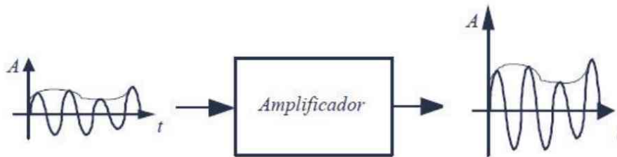
Figura 1.31. Efecto de la amplificación de una señal. Diagrama de bloque esquemático
