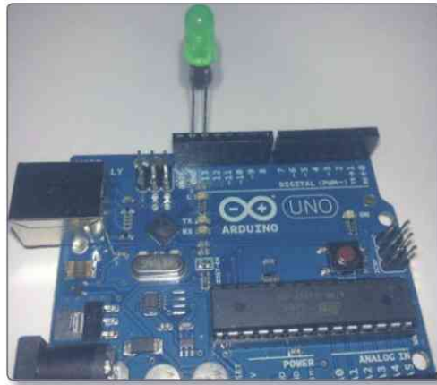
Figura 6.15. Imagen ejemplo de conexión LED a la placa Arduino UNO ( http://www.ajpdsoft.com/modules.php?name=News&file=article&sid=570 )
