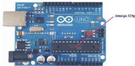
Figura 3.7. Placa Arduino UNO, microcontrolador ATmega 328p
