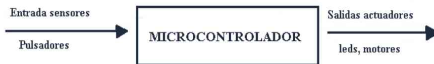
Figura 3.9. Esquema simplificado de un microcontrolador. Entradas y salidas procesadas
