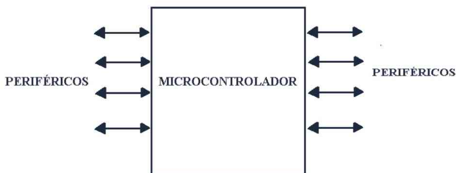
Figura 3.3. Esquema básico de un microcontrolador
