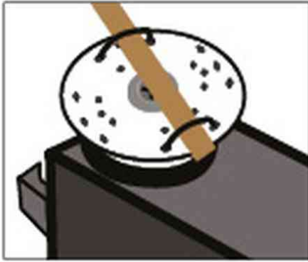
Figura 8.24: Fijación de la bandera al cuerno del servo.
