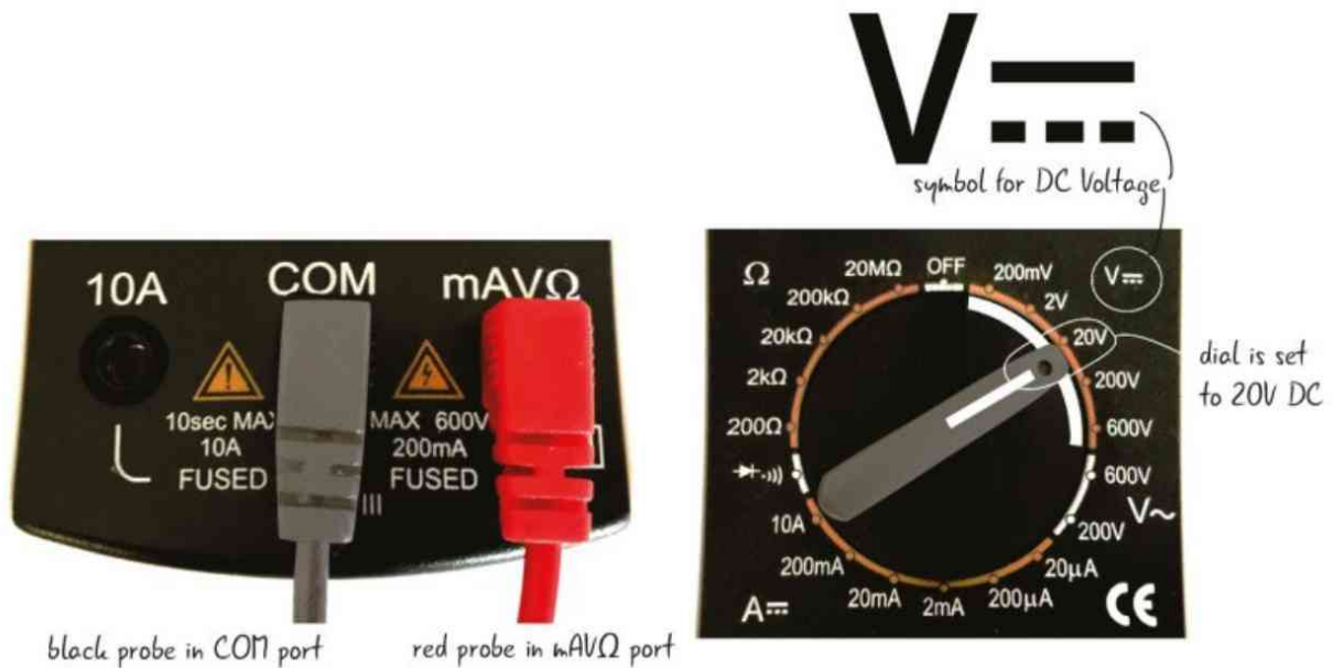
FIGURA 5.16 Preparación del multímetro para medir el voltaje en C.C.
