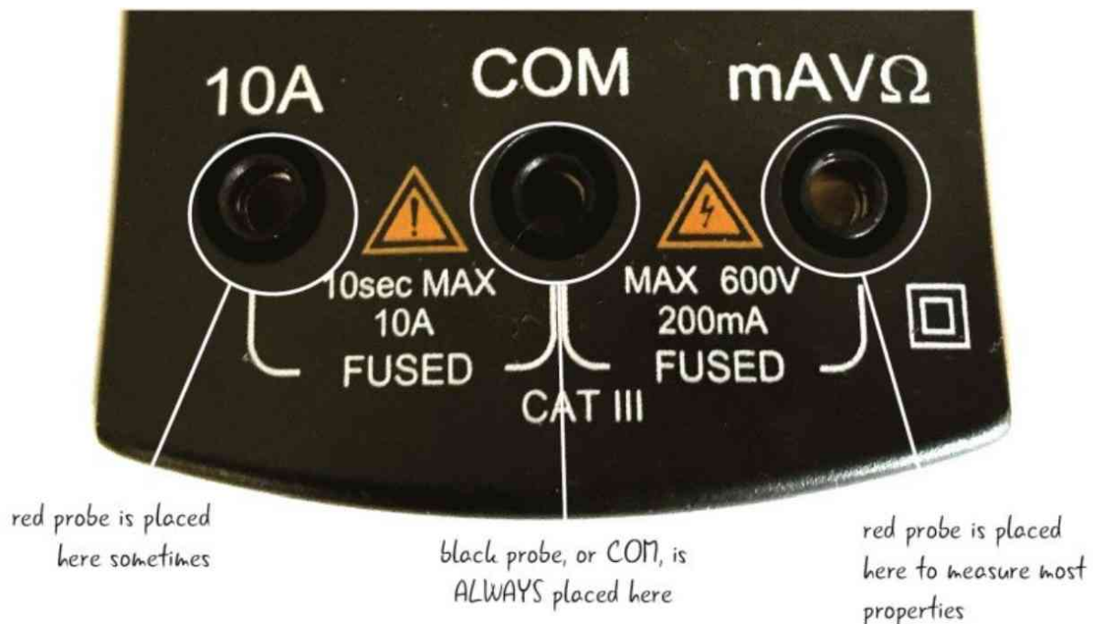
FIGURA 3.40 Puertos del multímetro.
