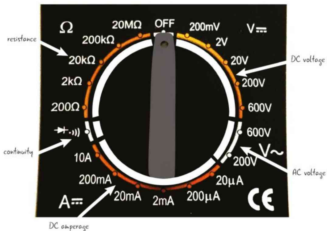
FIGURA 3.38 Dial del multímetro con las características eléctricas que puede medir.
