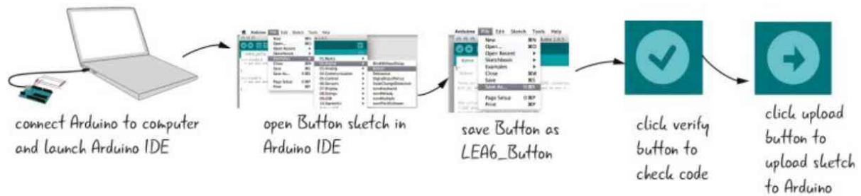
FIGURA 6.13 Procedimiento para cargar el código en el Arduino.
