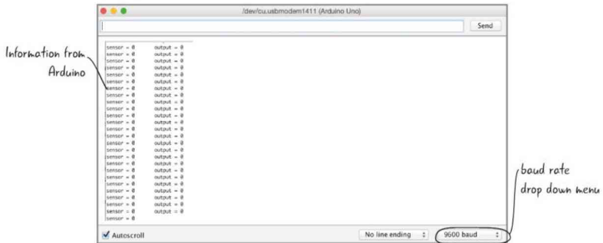
FIGURA 7.25 Ejecución del sketch en el monitor serie.
