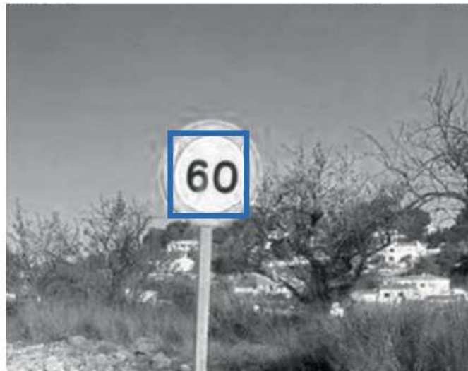
Figura 70. Componente roja con indicación de zona candidata a señal.
