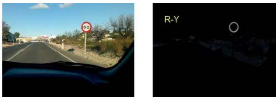
Figura 19. Imagen en color y la combinación R-Y. Los valores negativos de la resta se han saturado a cero.
