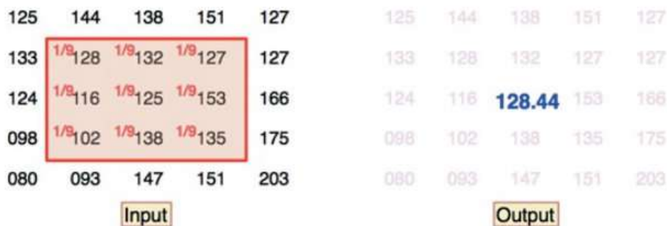
Figura 24. Ejemplo de operador local. La salida en un píxel es la media de una región de tamaño 3 x 3 de la entrada.
