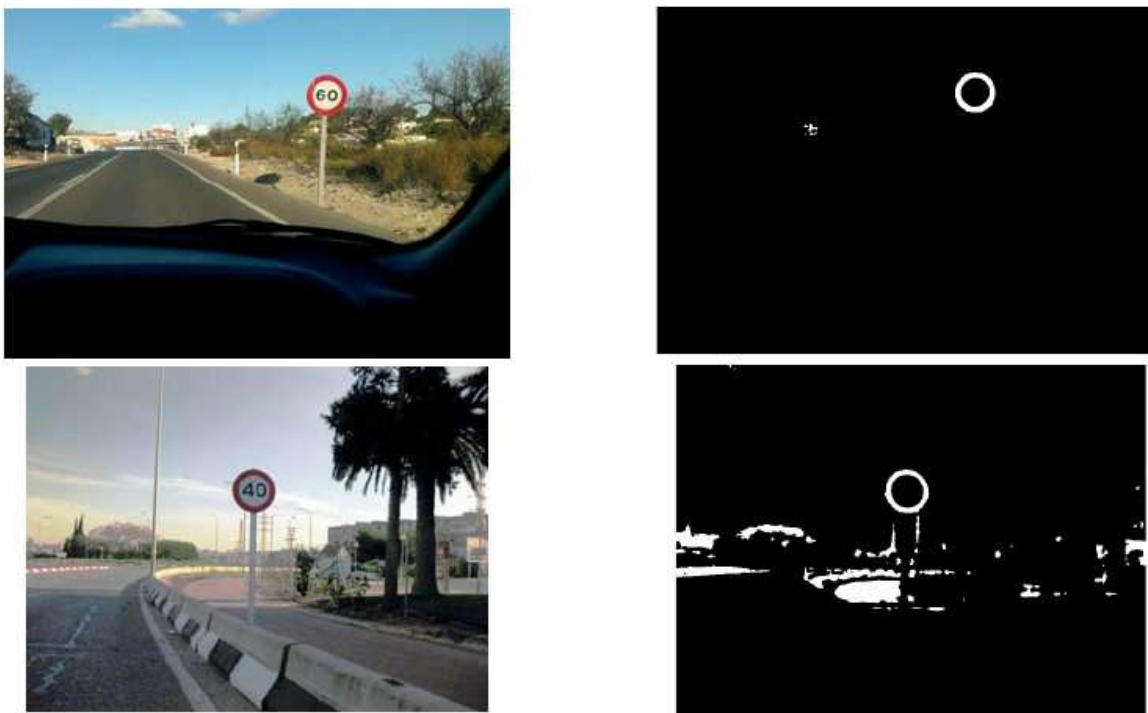
Figura 50. Resultado de la binarización al aplicar en ambos casos un umbral U = M/4 .
