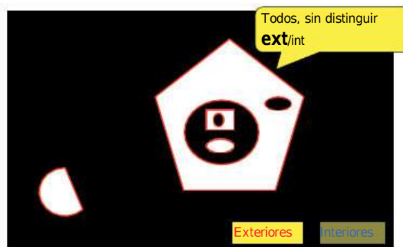
Figura 64. Resultado de findContours() con la opción RETR LIST. No se distingue entre exterior e interior. Todos los contornos se devuelven como exteriores.
