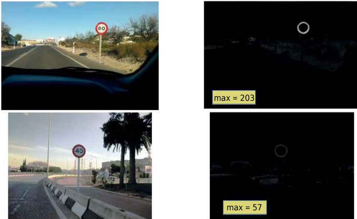
Figura 49. Dos imágenes con diferentes iluminaciones y sus respectivos resultados del preproceso para detectar zonas rojas.
