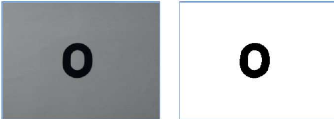
Figura 53. Imagen de entrada bimodal y resultado de la umbralización automática con Otsu.
