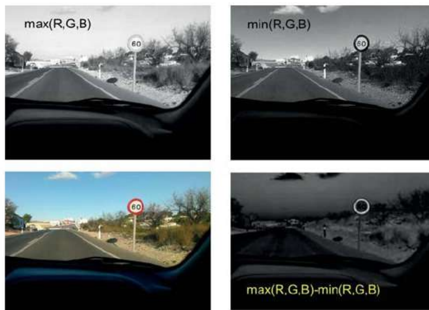
Figura 20. Combinación no lineal de las componentes RGB con el fin de discriminar entre zonas coloreadas y zonas grises.
