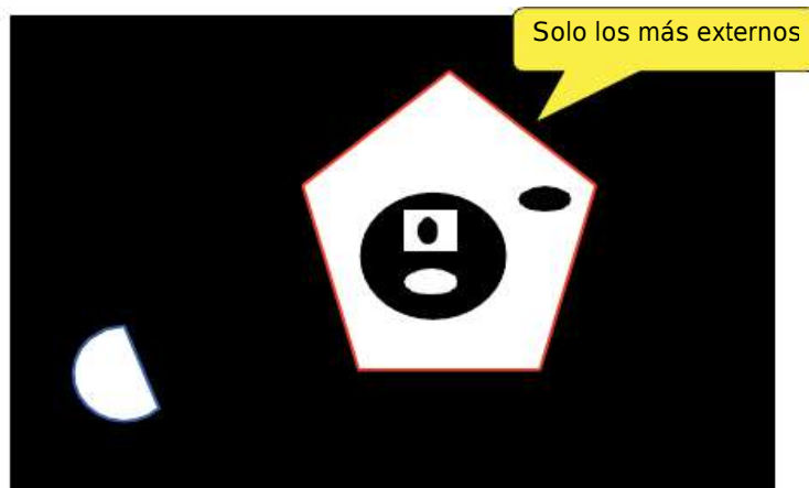
Figura 65. Resultado de findContours() con la opción RETR_EXTERNAL . Solo se devuelven los contornos exteriores.
