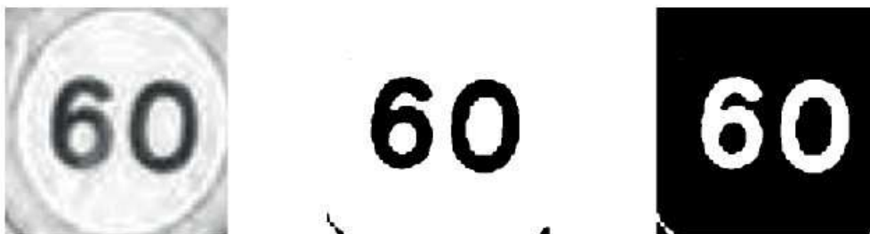
Figura 71. Zona recortada, binarización automática con Otsu, y lo mismo, pero invertido.
