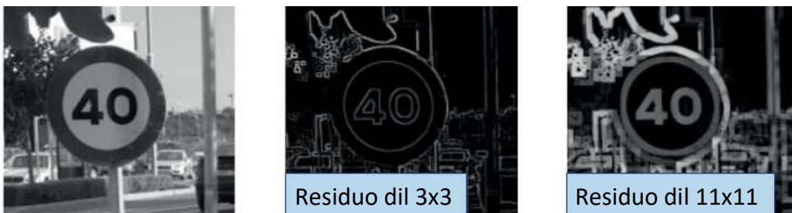
Figura 45. Efecto del cambio del tamaño de la dilatación en el residuo.
