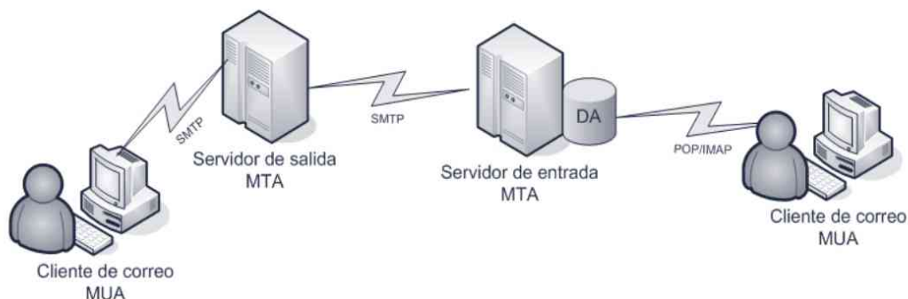
Figura 3-7. Arquitectura del sistema de correo electrónico.
