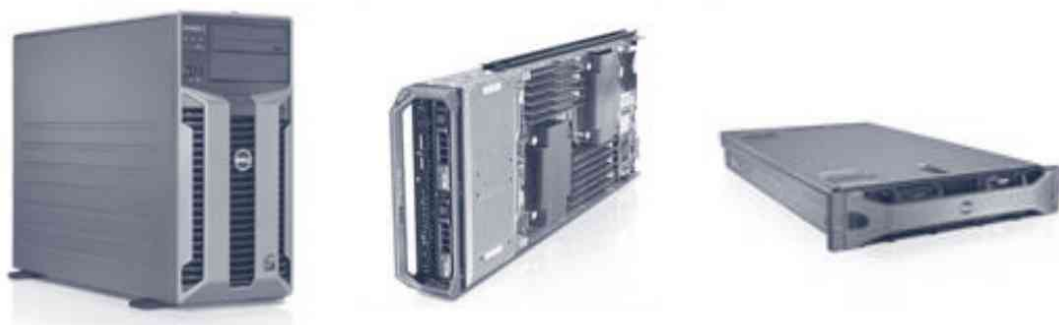
Figura 1-4. Tipos de servidores: a) Torre; b) Blade; c) Rack
