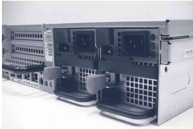
Figura 1-6. Servidor con fuente de alimentación redundante
